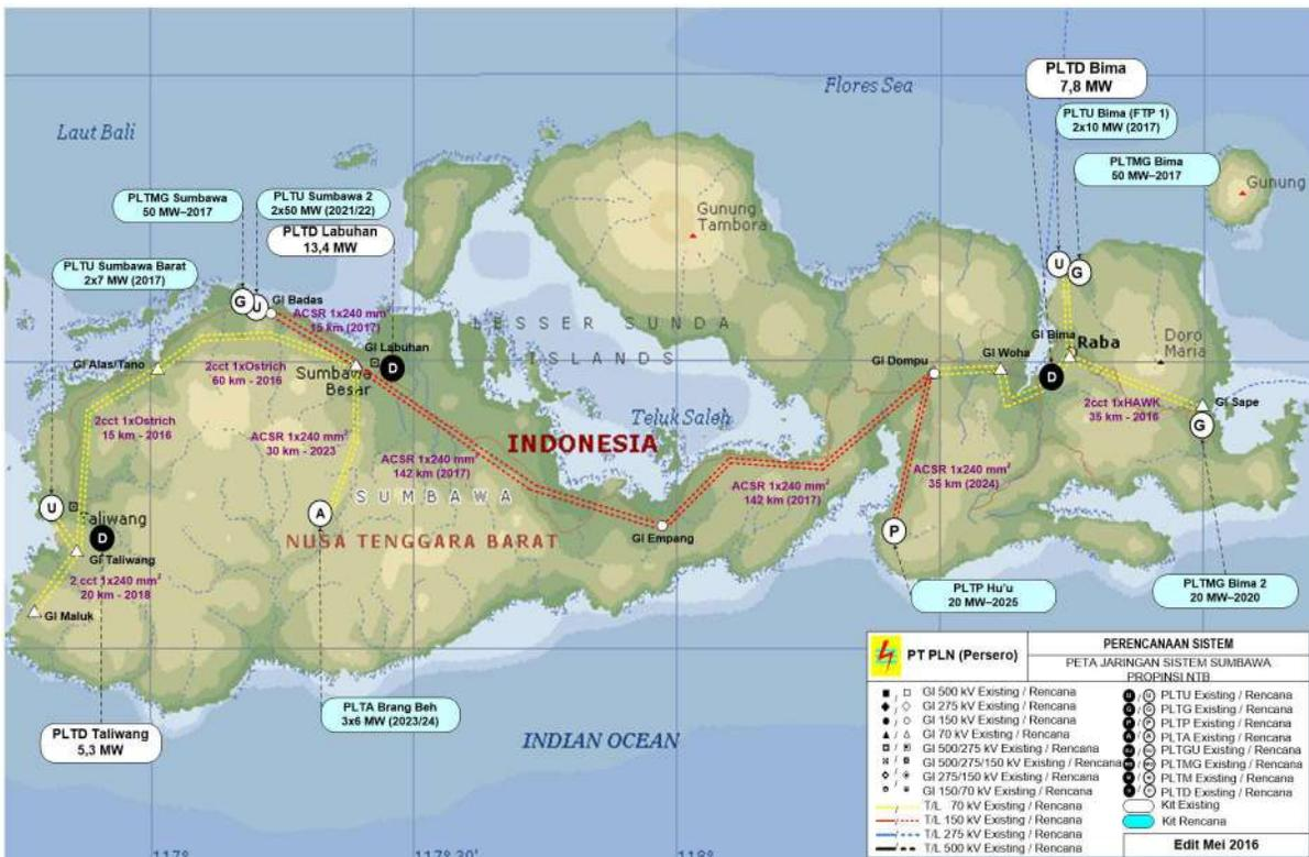
Gambar C16.3 Peta rencana pengembangan sistem 150 kV dan 70 kV di pulau Sumbawa
