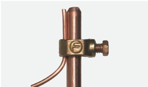
Penyambungan konduktor pembumian dengan elektrode bumi, pastikan sambungannya kencang sesuai PUIL Bagian 5-54 subayat 542.3.2 CATATAN 1 MOD klem pada elektrode pipa harus menggunakan baut dengan diameter minimal 10 mm
