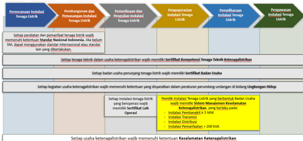
Gambar 2. Penerapan Keselamatan Ketenagalistrikan sesuai dengan Permen ESDM Nomor 10 Tahun 2021 tentang Keselamatan Ketenagalistrikan
