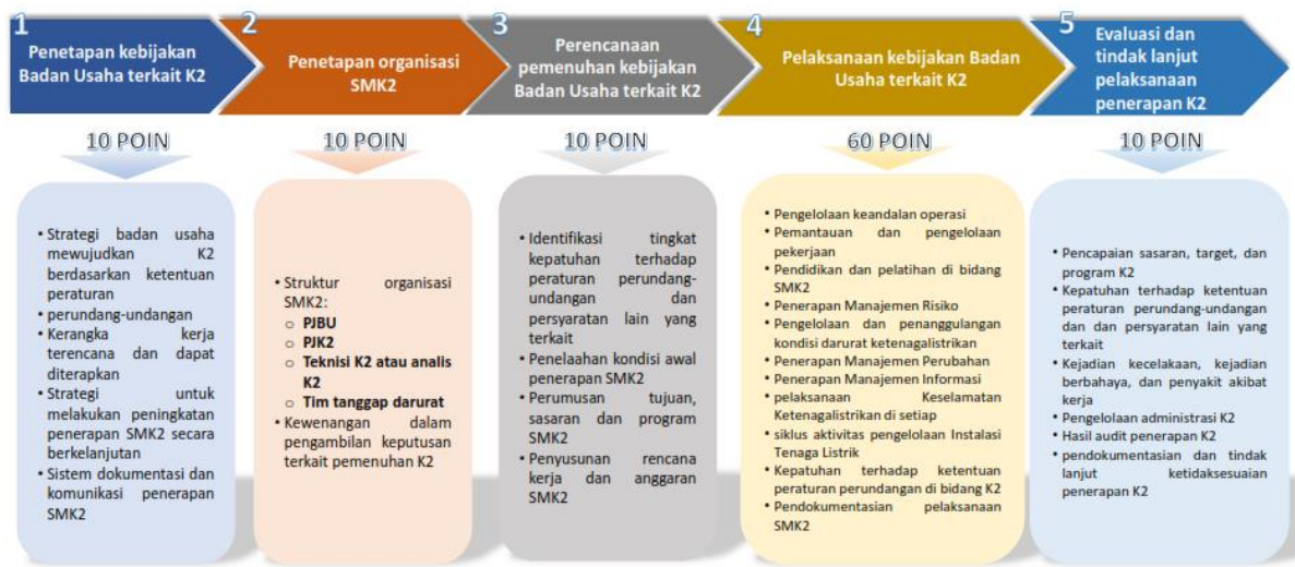
Gambar 5. Elemen Sistem Manajemen Keselamatan Ketenagalistrikan
